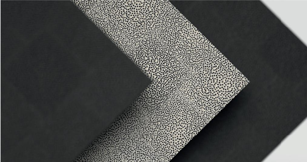
*karuun®* ist ein mit wenig Energieaufwand modifiziertes Naturmaterial aus dem Stamm der Rattanpalme. *karuun® shine* besitzt einzigartige Eigenschaften. Durch seine typische Punktstruktur entstehen bei der Verarbeitung von *karuun® shine* eine homogene Oberfläche mit dezentem Kachelmuster.
