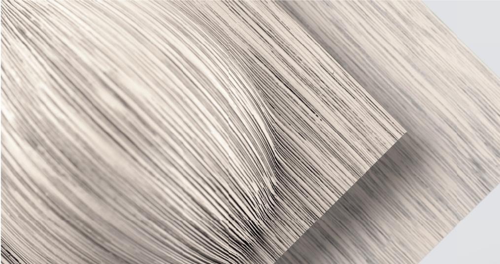
*karuun®* ist ein mit wenig Energieaufwand modifiziertes Naturprodukt aus dem Stamm der Rattanpalme. Durch die typisch lineare Faserstruktur sind bei der Verarbeitung keine sichtbaren Übergänge, wie bei herkömmlichen Furnieren, zu beobachten.
